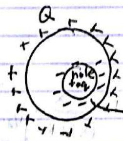
$$x \quad P_E = ? \quad \begin{matrix} \text{surface} \\ \text{encloses} \\ \sim \frac{(Q+q)}{\epsilon_0} \end{matrix}$$
